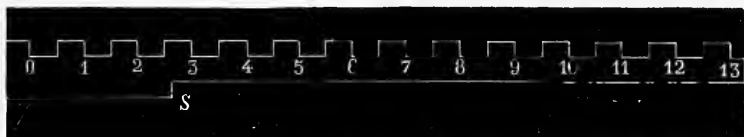
Fig. 77. — Ligne supérieure : tracé des secondes, 1, 2, 3, etc., inscrites électriquement. — Ligne inférieure : signal d'un phénomène; il se produit à l'instant S.
